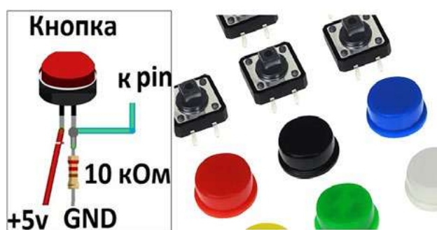
Рис. 1. Схема подключения тактовой кнопки к микроконтроллерной плате
